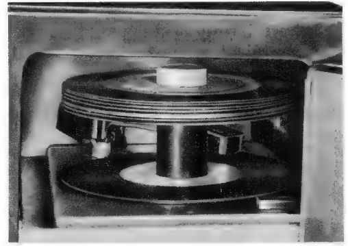
Bild 11. Dieser Zehnplattenwechsler für 17-cm-Kleinplatten (45 U/min) ist in die rechte Schmalseite des Telefunken-Empfängers „Wunschkonzert“ eingebaut (links das vollständige Gerät, rechts Blick in den Wechsler-Raum)
