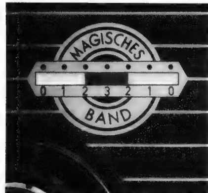
Bild 4. Das magische Band EM 84 fügt sich harmonisch in die Skalen einiger neuer Empfänger ein
